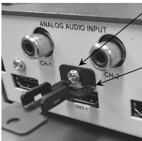
CL-1 金具を実装した状態
