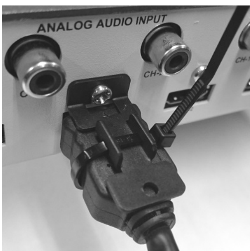
くびれのある HDMI プラグとの束線縛り例
